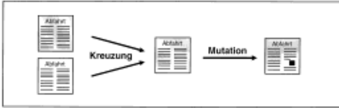
Bild 4: Zur Erzeugung von ‚Nachkommen‘ werden zwei zufällig ausgewählte Fahrpläne zu einem neuen Fahrplan rekombiniert und einer kleinen zufälligen Änderung unterworfen.
