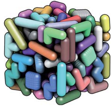
Abbildung 8: Tetris-artige Partikelformen demonstrieren die Möglichkeiten heteromorpher Packungen.
